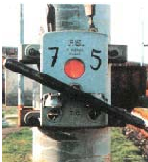
Figura 7: Argano in posizione di chiuso
