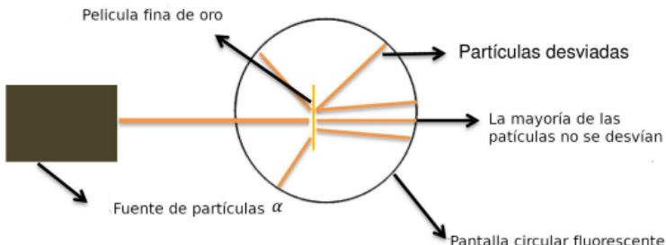
**Figura:** Arreglo experimental para la dispersión de Rutherford.
