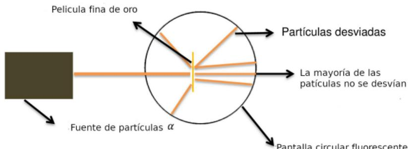
**Figura:** Arreglo experimental para la dispersión de Rutherford. Imagen adaptada a partir de “File:Peliculafinadeouro.jpg” por Costa Isa 14 con una licencia CC BY-SA 4.0
